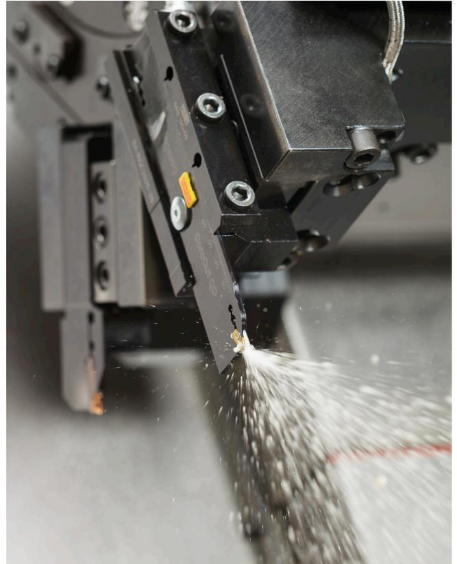
Atualmente, os desafios do uso de refrigeração de alta precisão para melhorar o desempenho em cortes e canais podem ser superados quando temos à disposição um conjunto de desenvolvimentos tecnológicos. Por exemplo, ferramentas com refrigeração interna de alta precisão que direcionam o fluxo de refrigeração exatamente na zona de corte (o ponto de contato entre a pastilha e a peça), atingindo espaços que podem fazer uma grande diferença para a usinagem.
